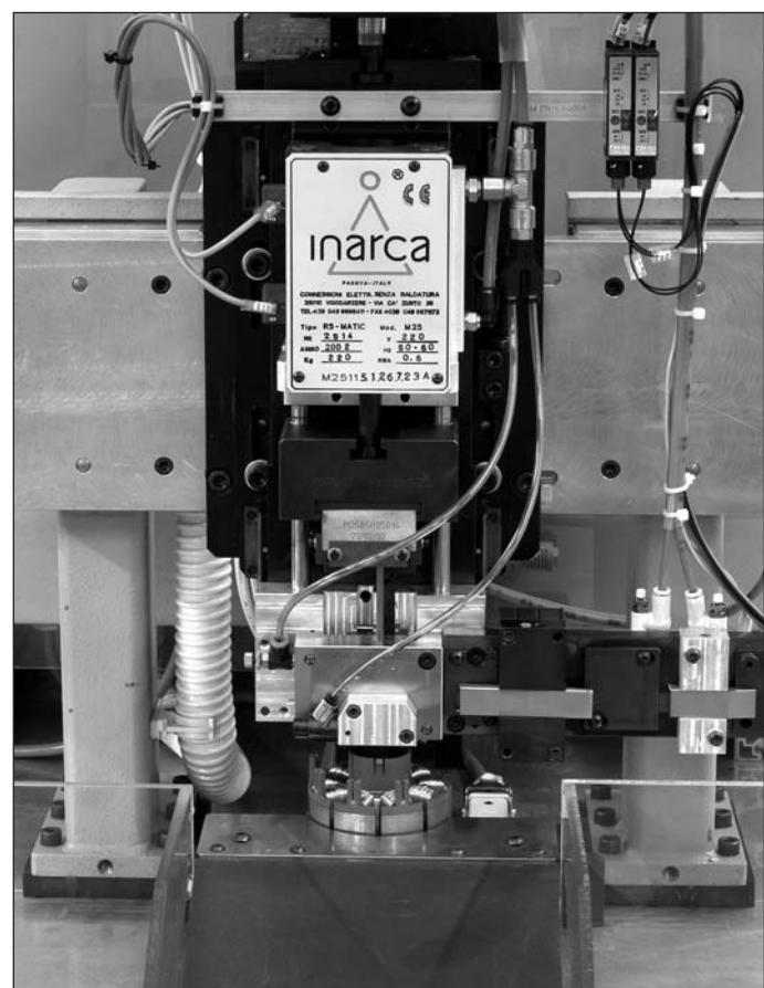
**M 25 2 E:** Macchina da banco Inar Rs, circolare, 2 pallet con tavola rotante per l'inserimento Inar Rs, unità inseritrice composta da supporto, cilindri, controllo fibre ottiche del passo, sistema aspirazione sfridi e kit inserimento ad alimentazione singola/doppia e banco di sostegno, impianto elettrico e pneumatico inclusi.
